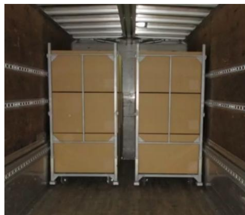
10tトラックへの積載を意識して設計されている
